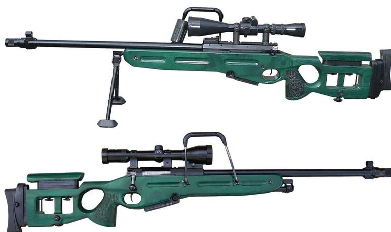
7,62 мм снайперская винтовка СВ-98 с оптическим прицелом предназначена для уничтожения различных появляющихся открытых и замаскированных одиночных целей на дальностях до 1000 метров (рис. 24).
