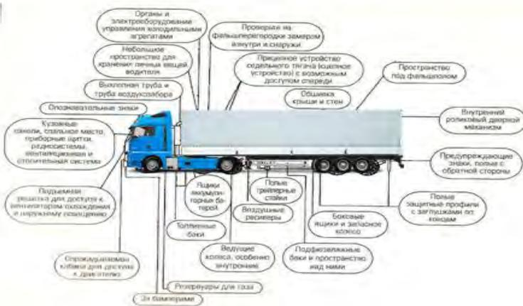
Рис. 7.4. Места поиска запрещенных предметов в грузовом автомобиле
