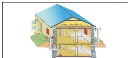
Подвальное помещение с противорадиационным укрытием
