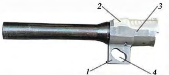
Рис. 110. Ствол: 1 – нижний выступ муфты; 2 – верхний выступ муфты; 3 – муфта; 4 – кулачковый паз
