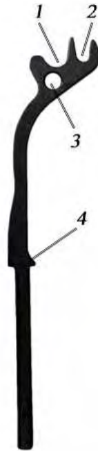
Рис. 114. Толкатель: 1 – большая проушина; 2 – малая проушина; 3 – отверстие; 4 – выступ
