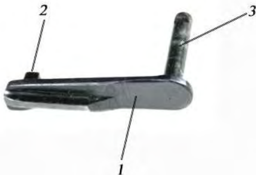
Рис. 57. Затворная задержка: 1 – стержень; 2 – лопасть; 3 – выступ
