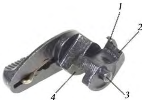
Рис. 71. Предохранитель: 1 – зацеп; 2 – выступ; 3 – цапфа; 4 – ребро
