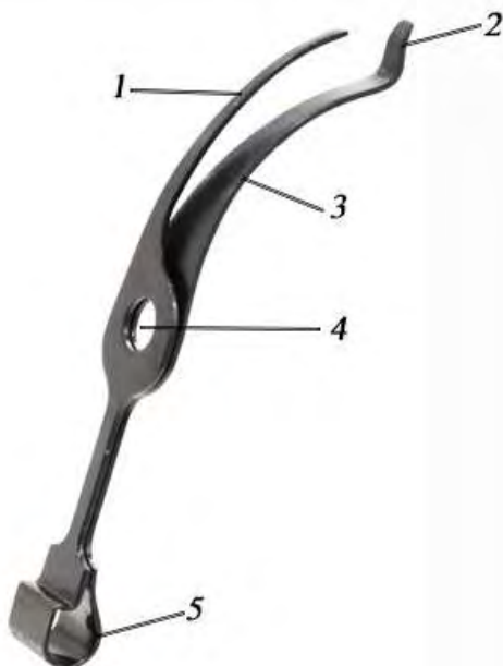
Рис. 66. Боевая пружина: 1 – узкое перо; 2 – изгиб; 3 – широкое перо; 4 – отверстие; 5 – защелка магазина
