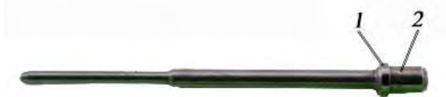
Рис. 112. Ударник: 1 – упор; 2 – головка
