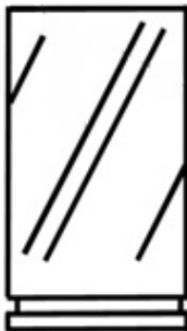
Рис. 101. Следы винтовых канавок на корпусе гильзы
