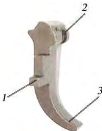
Рис. 88. Разобщик: 1 – выступ; 2 – цапфа; 3 – хвост
