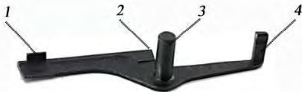
Рис. 19. Затворная задержка: 1 – отражающий выступ (отражатель); 2 – выступ для удержания кожуха-затвора; 3 – цапфа; 4 – выступ
