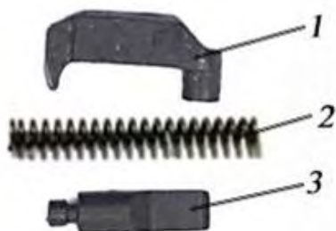
Рис. 20. Выбрасывающий механизм: 1 – выбрасыватель; 2 – пружина; 3 – гнеток
