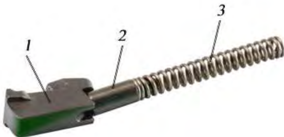
Рис. 69. Выбрасывающий механизм: 1 – выбрасыватель; 2 – гнеток; 3 – пружина выбрасывателя
