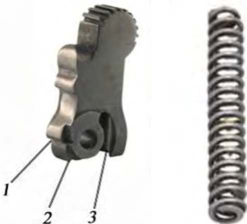
Рис. 50. Курок с боевой пружиной: 1 – предохранительный взвод; 2 – боевой взвод; 3 – гнездо для боевой пружины
