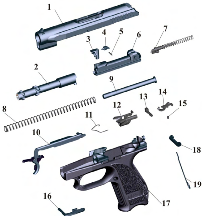
Рис. 131. Детали и механизмы 9,0-мм пистолета ГШ-18: 1 – кожух затвора; 2 – ствол; 3 – выбрасыватель; 4 – ограничитель; 5 – ось; 6 – затвор; 7 – ударник с втулкой и боевой пружиной; 8 – возвратная пружина; 9 – шток; 10 – спусковой крючок с тягой и предохранителем; 11 – пружина разобщителя; 12 – отражатель; 13 – разобщитель; 14 – шептало; 15 – пружина шептала; 16 – затворная задержка; 17 – рамка с рукояткой; 18 – фиксатор магазина; 19 – пружина фиксатора
