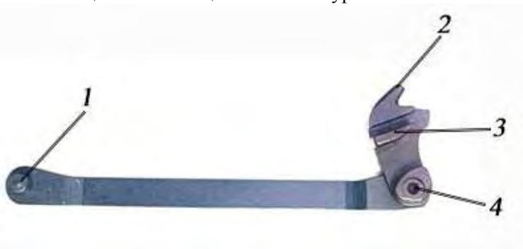
Рис. 68. Спусковая тяга с рычагом взвода: 1 – цапфа; 2 – разобщик; 3 – выступ; 4 – цапфа
