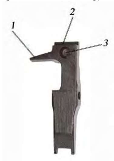
Рис. 116. Шептало: 1 – зуб; 2 – носик; 3 – отверстие
