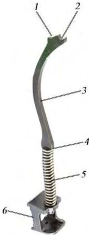
Рис. 85. Боевая пружина с толкателем и защелкой магазина: 1 – выступ; 2 – выем; 3 – толкатель; 4 – уступы для опоры боевой пружины; 5 – боевая пружина; 6 – защелка магазина
