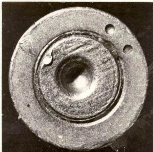
Рис. 22. Следы на торце донной части гильзы
