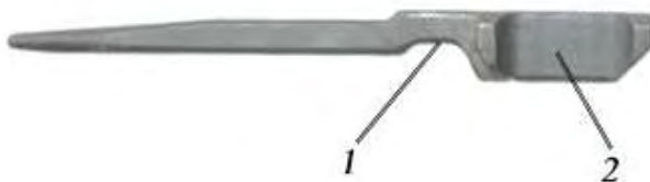
Рис. 83. Ударник: 1 – выемка; 2 – утолщение
