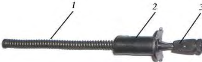
Рис. 34. Возвратный механизм: 1 – шток с возвратной пружиной; 2 – муфта; 3 – головка штока
