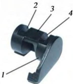
Рис. 21. Предохранитель: 1 – вырез; 2–4 – пазы
