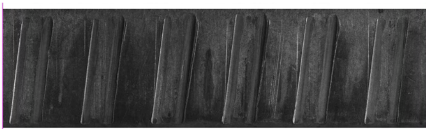
Рис. 142. Фоторазвертка пули, выстрелянной из 9,0-мм пистолета ПЛК
