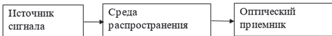
Рисунок 1. Структура оптического канала утечки информации.
