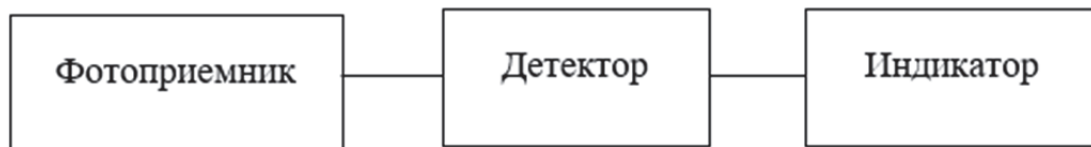
Рисунок 4. Блок-схема устройства обнаружения модуляции электромагнитных волн в видимом диапазоне
