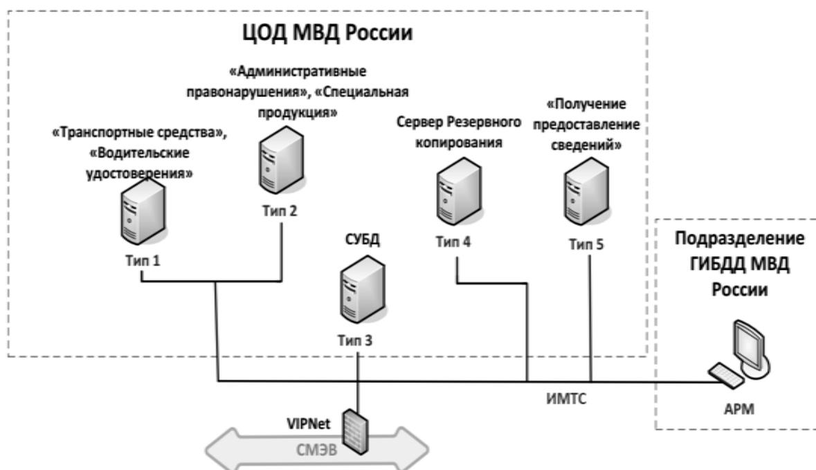
**Рисунок 3.1.1. Схема технических средств ФИС ГИБДД-М<sup>19</sup>.**
