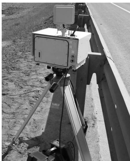
**Рисунок 5.2.5. Пример развертывания АПК «КРИС-П».**
