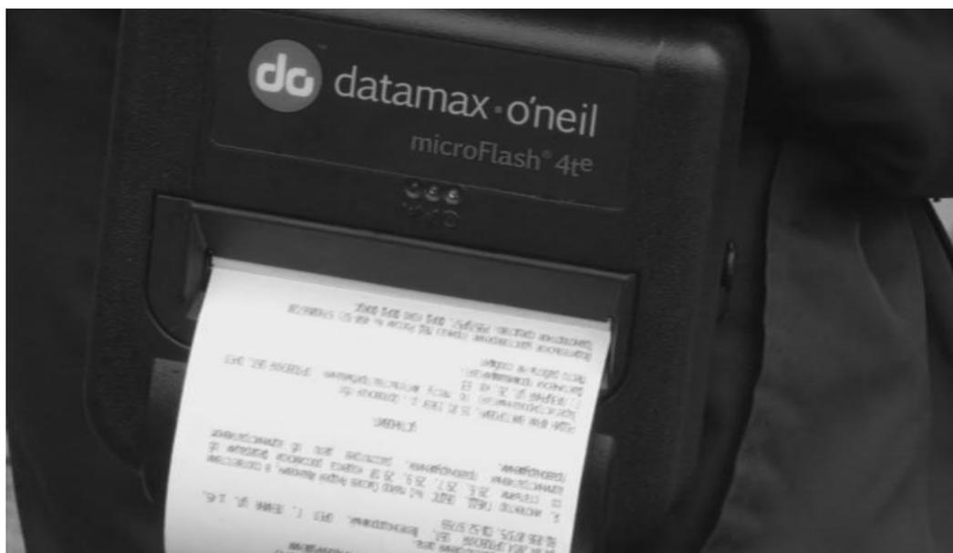
**Рисунок 5.1.2. Мобильный принтер АРМ инспектора ДПС (МИГ-ИДПО).**
