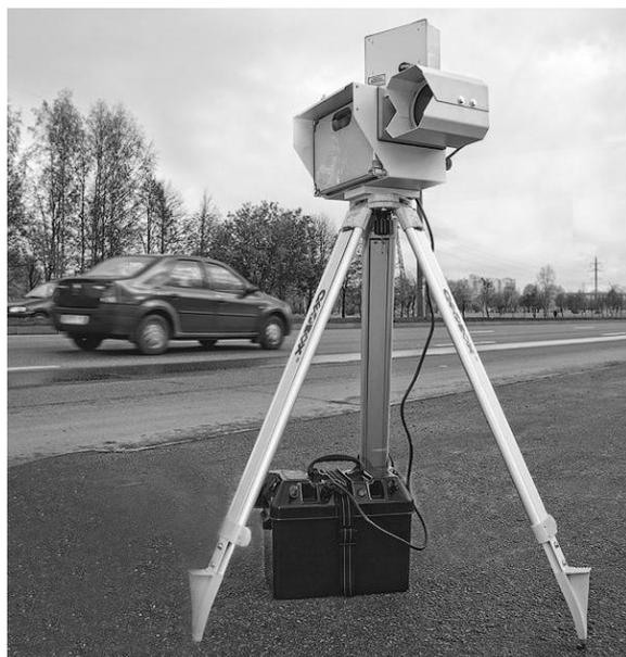
**Рисунок 5.2.3. Передвижной вариант АПК «Арена».**
