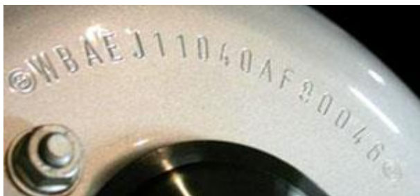
Штамповка VIN on a BMW Z8
