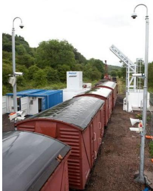
Рис. 8.13. Рельсовый инспекционно-досмотровый комплекс Eagle R90.
