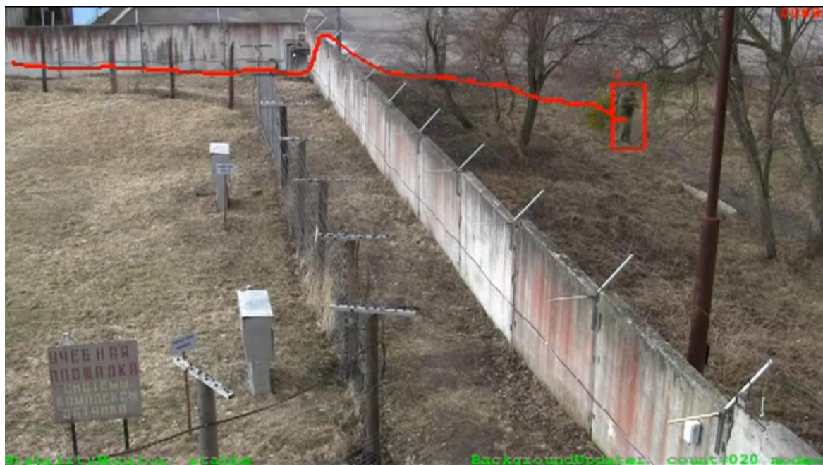
Рис. 8.24. Пример работы периметральной видеоаналитики.
