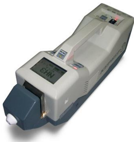
Рис. 8.15. Портативный ионно-дрейфовый детектор «Кербер».
