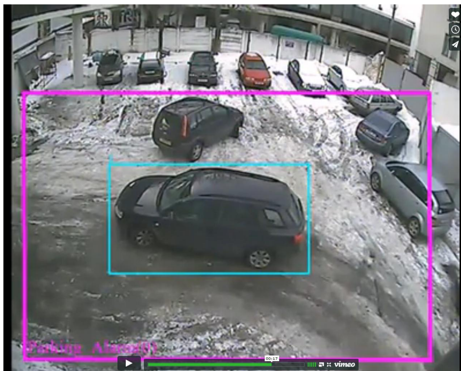
Рис. 8.20. Неправильная парковка в сигнальной зоне.
