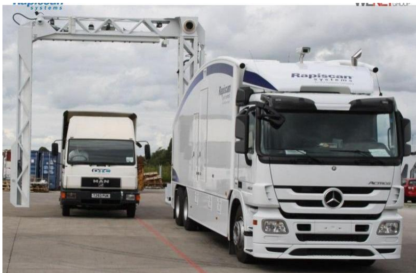
Рис. 8.12. Мобильный инспекционно-досмотровый комплекс Eagle M45.
