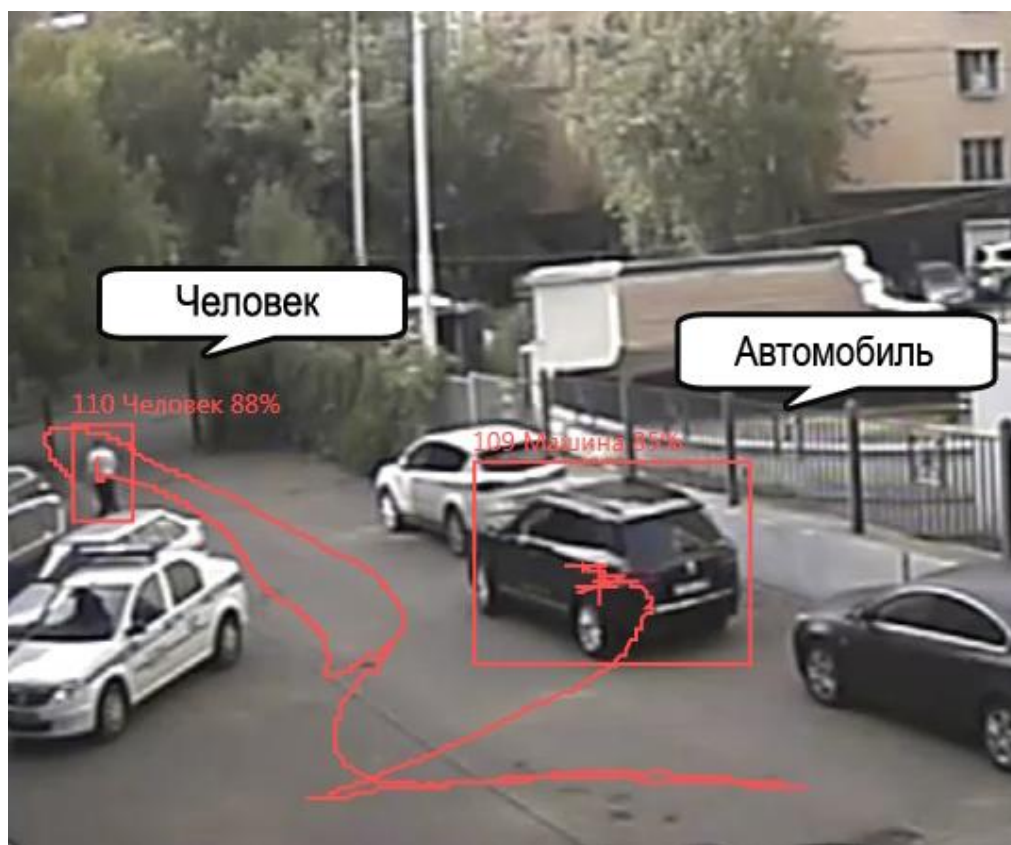
Рис. 8.18. Работа типового классификатора объектов.
