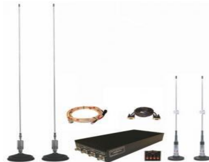
Рис. 8.30. Блокиратор радиовзрывателей автомобильный.
