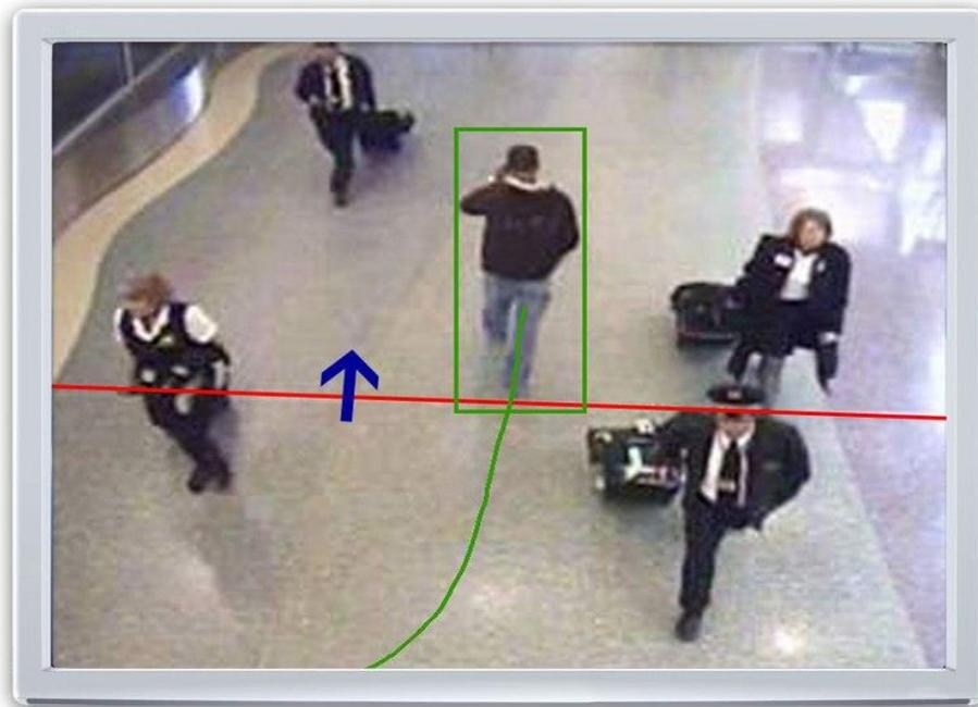
Рис. 1.11 (б). Обнаружение движения в определенном направлении.
