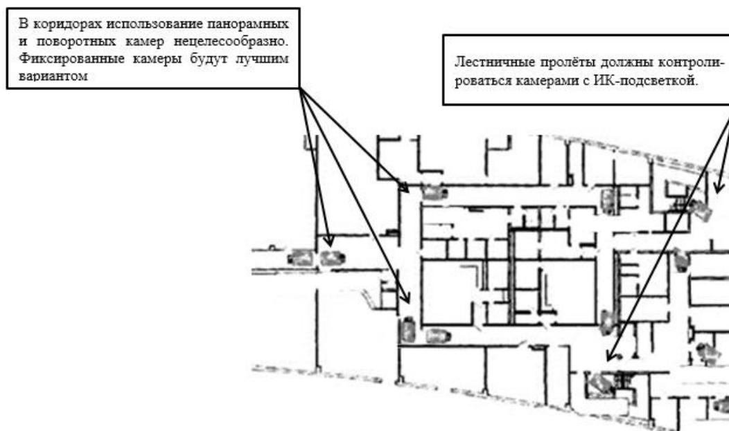
Рисунок 2.6. Схема расположения видеокамер в технических помещениях и коридорах.
