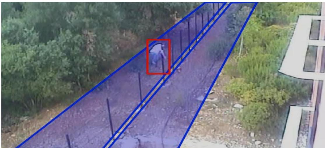
*Рис. 1.7. Обнаружение преодоления ограждения.*
