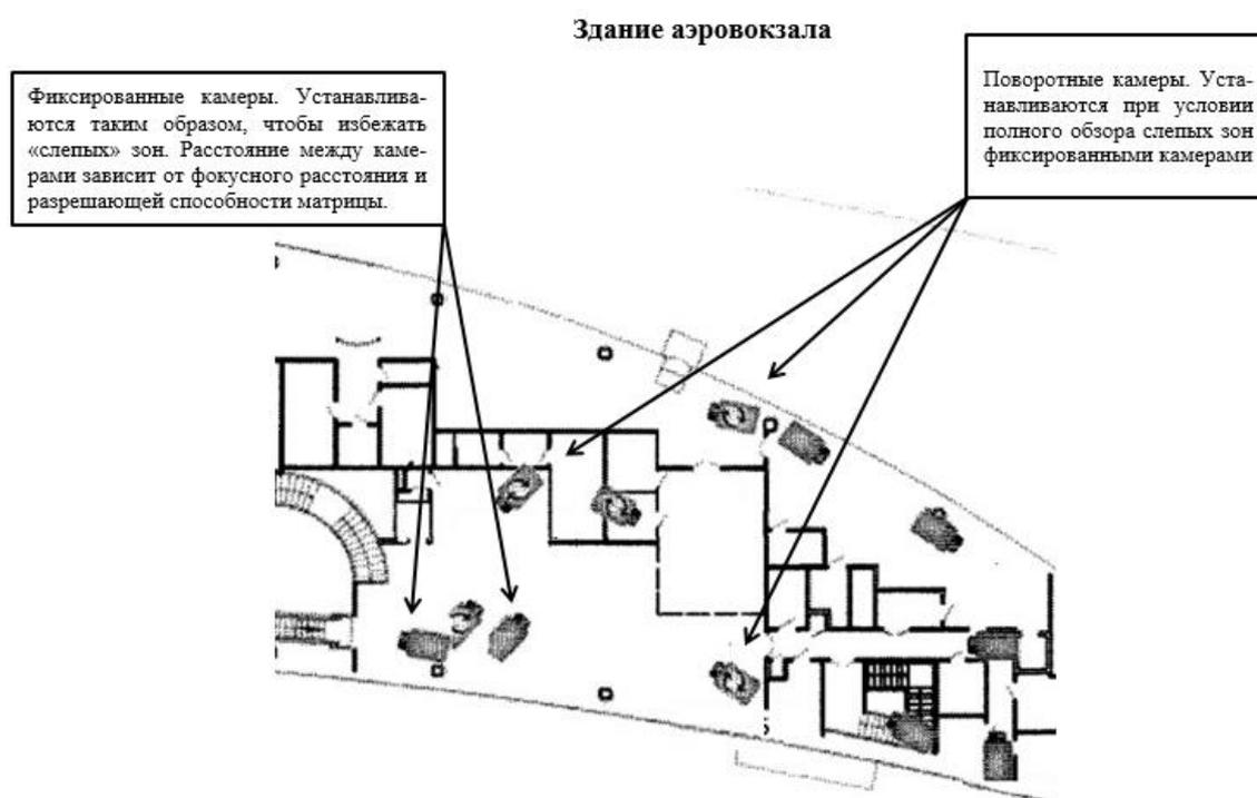
*Рисунок 2.4. Схема расположения видеокamer в здании аэровокзала.*
