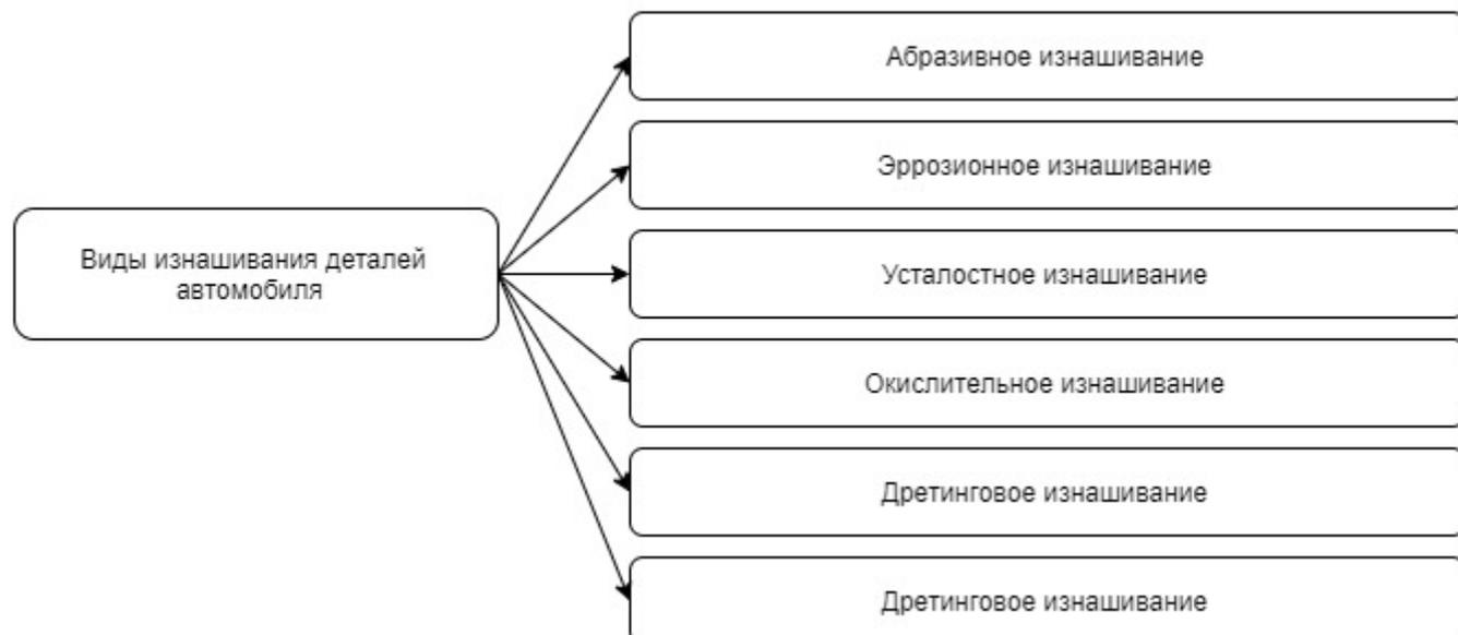
Рис. 5. Виды изнашивания деталей автомобиля
