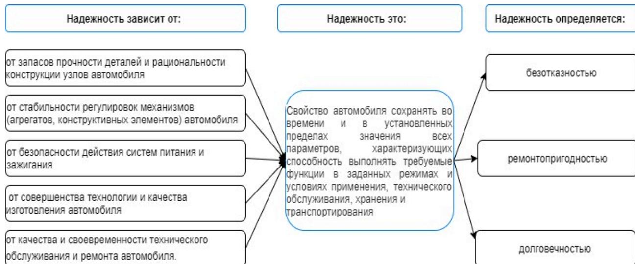
Рис. 2. Предпосылки и признаки надежности автомобиля
