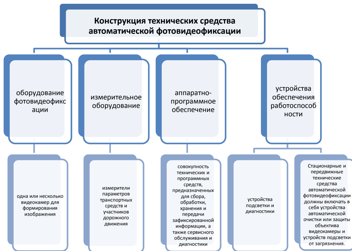
Рис. 4. Конструкция технических средств автоматической фотовидеофиксации
