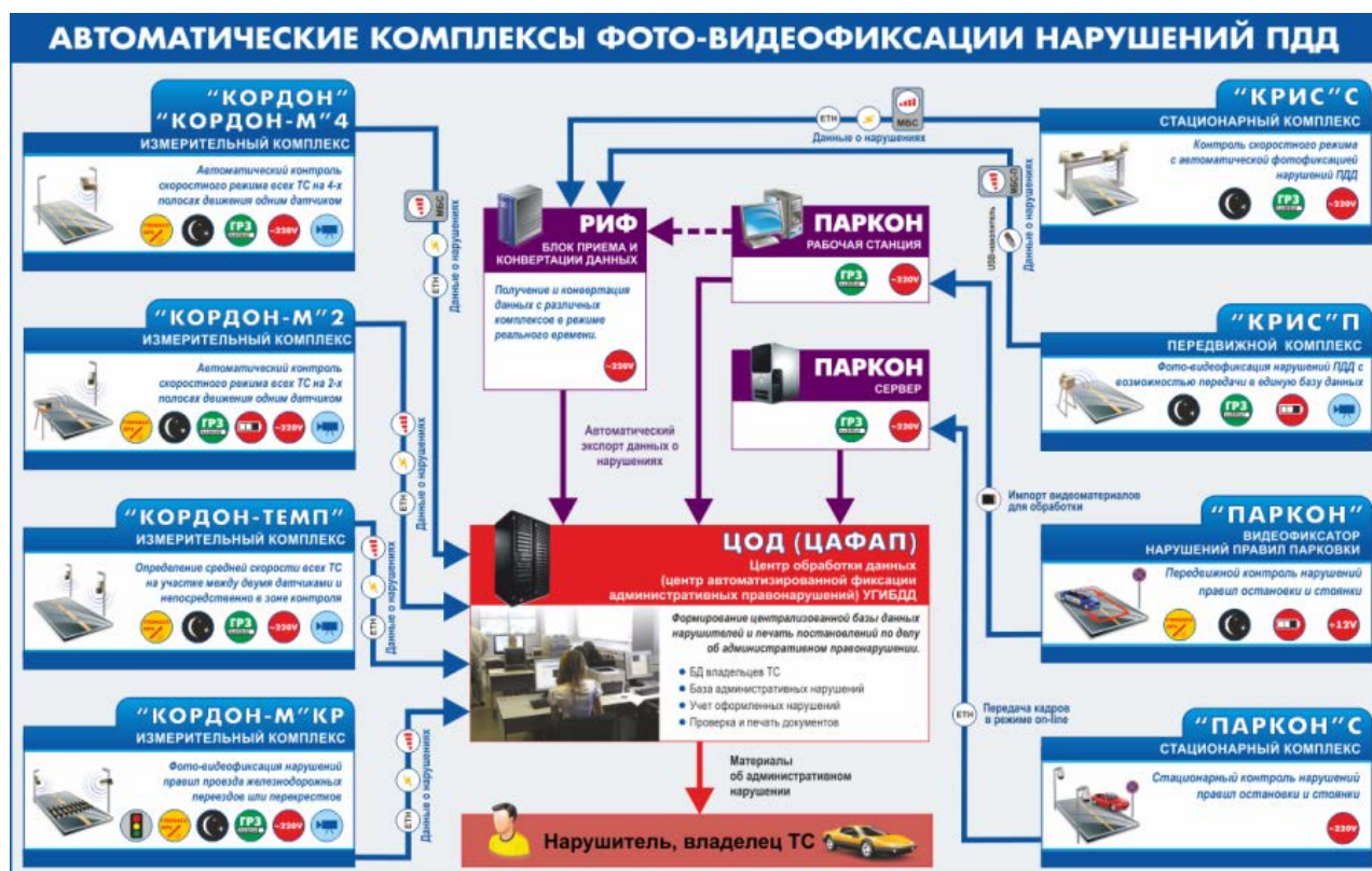
Рис. 5. Общий принцип работы измерительного комплекса с видеофиксацией
