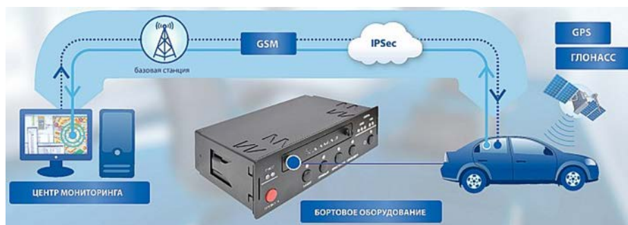
Рис. 6. Общая схема работы спутниковой навигационно-мониторинговой системы
