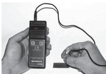
Рис. 41. Вихретоковый индикатор «СФИНКС ВИ-98»
