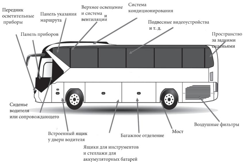
Рис. 28. Проверка автобуса
