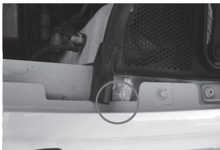
Рис. 8. Досмотр мест соединений деталей кузова (в качестве примера в области креплений переднего крыла)
