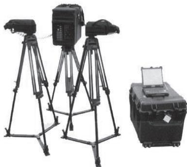
Рис. 37. Переносной комплекс обнаружения взрывчатых веществ в багаже и транспортных упаковках «ШЕЛЕСПЕР»
