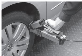
Рис. 47. Рентгеновский сканер скрытых полостей «ВАТСОН»
