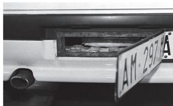
Рис. 7. Вариант размещения тайника с незаконно перевозимыми предметами (далее — НПП) за государственным регистрационным знаком
