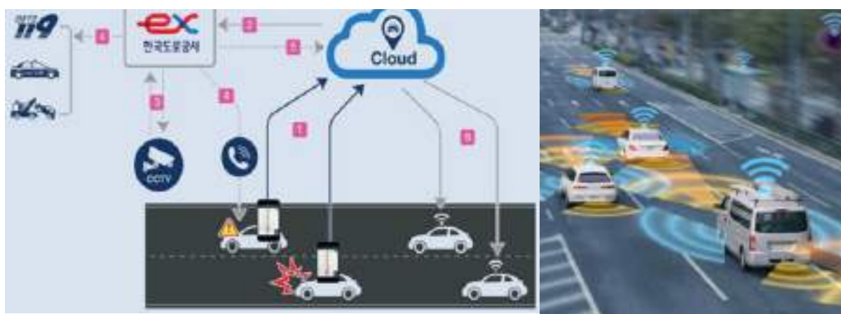
Рисунок 7. Принцип работы кооперативных интеллектуальных транспортных систем
