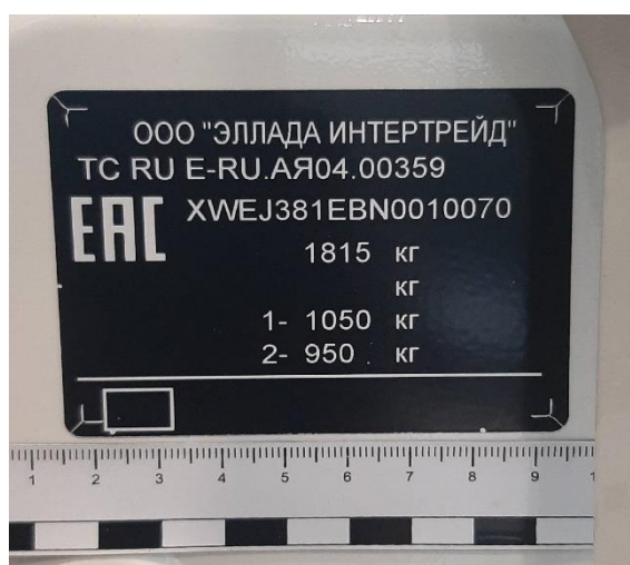
Рис. 2.45. Заводская маркировочная табличка автомобиля KIA Soul
