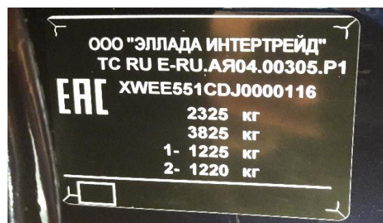
Рис. 2.5. Заводская маркировочная табличка с российским VIN
