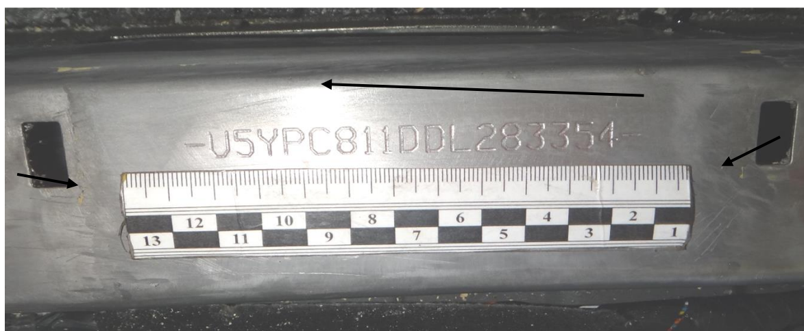
Фото 5. Сварные швы с лицевой стороны маркируемой панели
