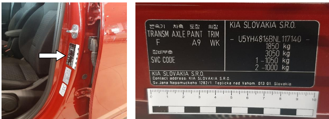
Рис. 2.16. Словацкий VIN на заводской маркировочной табличке
