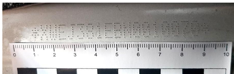
Рис. 2.43. VIN под передним пассажирским сиденьем автомобиля KIA Soul
