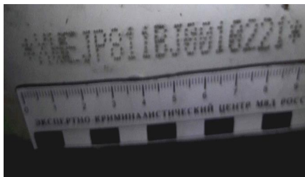
Рис. 2.44. VIN на лонжероне автомобиля KIA Soul
