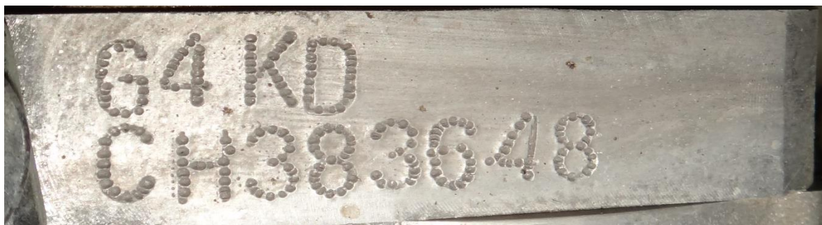
Фото 10. Маркировочная площадка двигателя
