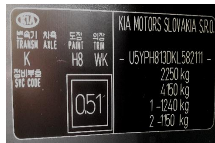
Рис. 2.50. Заводская маркировочная табличка автомобиля KIA Sportage
