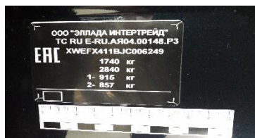
Рис. 2.57. Заводская маркировочная табличка автомобиля KIA Cerato
