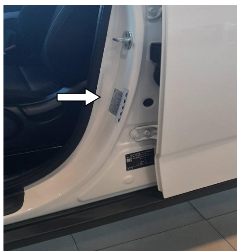
Рис. 2.45. Заводская маркировочная табличка автомобиля KIA Soul
