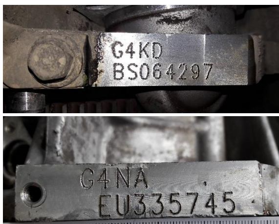
Рис. 2.54. Серийный номер двигателя
