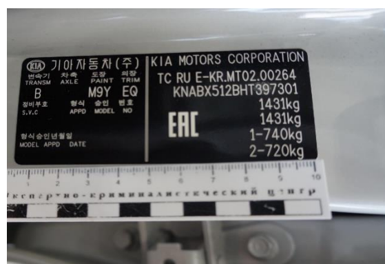
Рис. 2.62. Заводская маркировочная табличка автомобиля KIA Picanto
