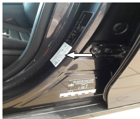
Рис. 2.25. Размещение заводских табличек на центральной стойке автомобиля KIA Optima
