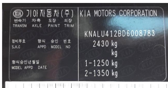
Рис. 2.67. Заводская маркировочная табличка автомобиля KIA Quoris со стороны водителя
