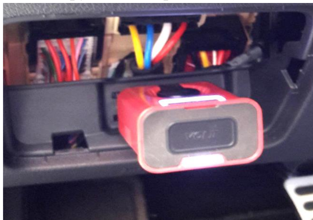
Рис. 2.10. Считывание VIN при помощи диагностического сканера автомобиля KIA Sorento
