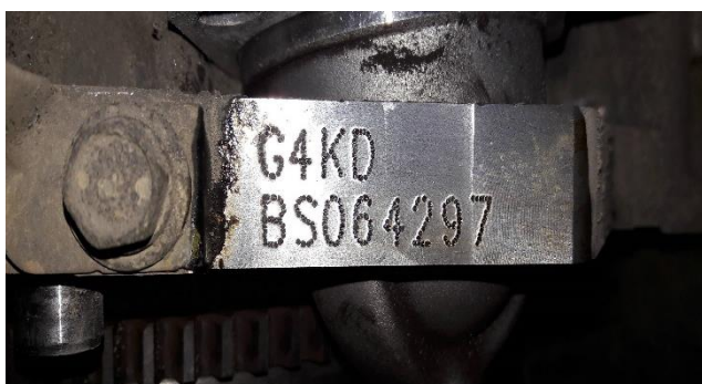
Рис. 2.27. Серийный номер двигателя автомобиля KIA Optima
