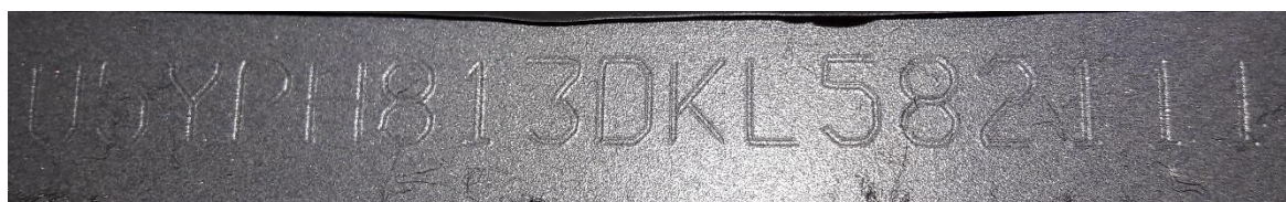
Рис. 2.51. VIN автомобиля KIA Sportage
