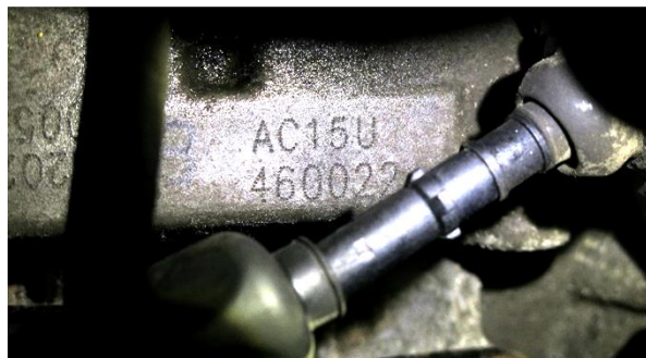
Рис. 2.38. Производственный номер КПП
