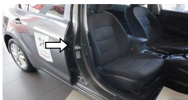
Рис. 2.57. Заводская маркировочная табличка автомобиля KIA Cerato
