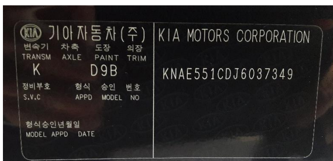
Рис. 2.4. Заводская маркировочная табличка с корейским VIN
