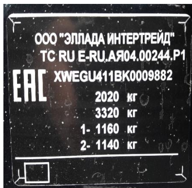
Рис. 2.24. Внешний вид заводских маркировочных табличек автомобиля KIA Optima
