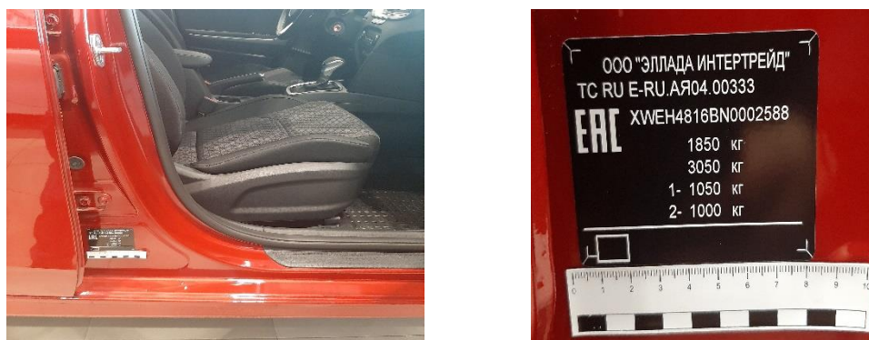
Рис. 2.17. Российский VIN на заводской маркировочной табличке
