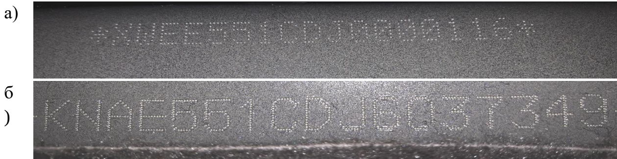
Рис. 2.3. Российский (а) и корейский (б) VIN под передним пассажирским сиденьем автомобиля
