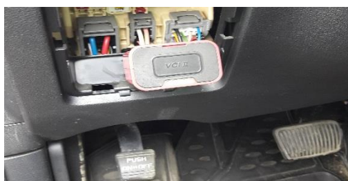
Рис. 2.55. Место расположения разъема для подключения диагностического сканера и считываемый с его помощью VIN
