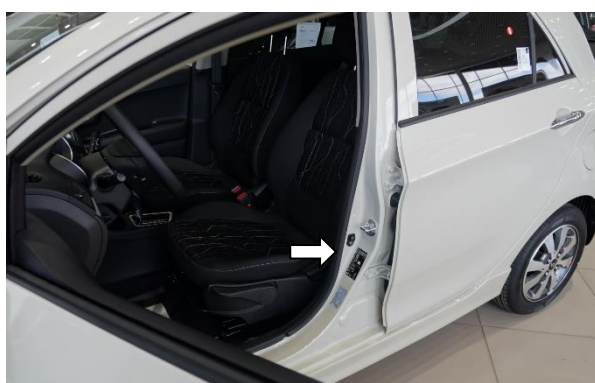
Рис. 2.62. Заводская маркировочная табличка автомобиля KIA Picanto
