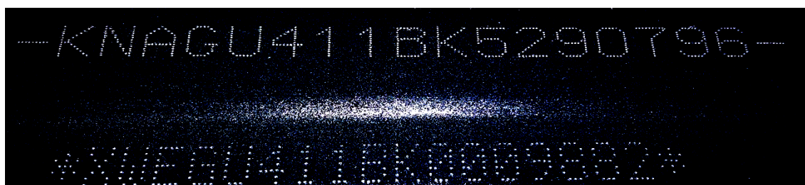
Рис. 2.26. Корейский и российский VIN VIN автомобиля KIA Optima
