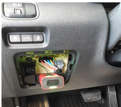
Рис. 2.30. Разъем для подключения диагностического сканера и считываемый с его помощью VIN
