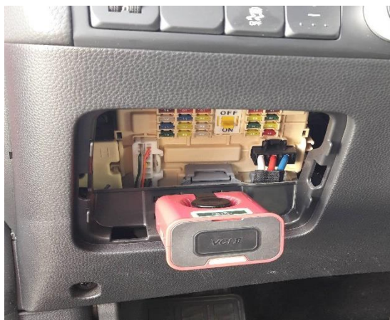
Рис. 2.47. Место расположения разъема для подключения диагностического сканера и считываемый с его помощью VIN
