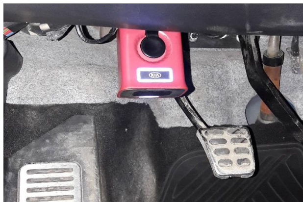
Рис. 2.39. Место расположения разъема для подключения диагностического сканера и считываемый с его помощью VIN
