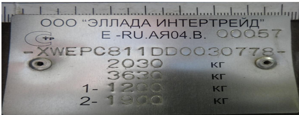
Фото 9. Металлическая табличка с идентификационным номером автомобиля (т. н. VIN)
