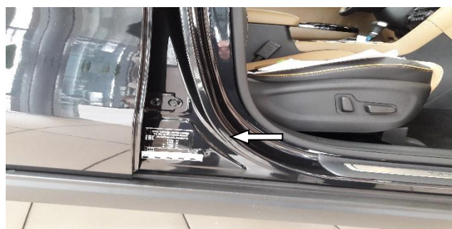
Рис. 2.52. Заводская маркировочная табличка автомобиля KIA Sportage
