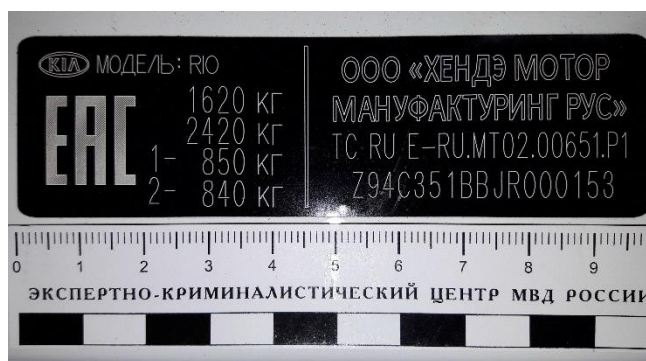
Рис. 2.34. Заводская маркировочная табличка
