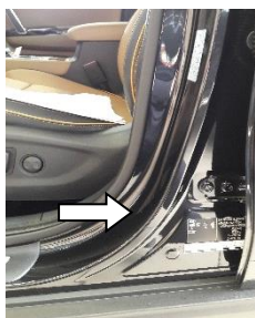
Рис. 2.50. Заводская маркировочная табличка автомобиля KIA Sportage
