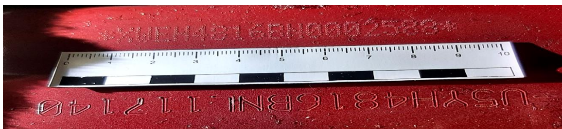
Рис. 2.18. Внешний вид VIN (российского и корейского) на площадке под передним пассажирским сиденьем автомобиля KIA Ceed
