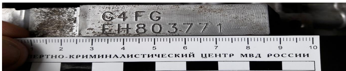
Рис. 2.21. Серийный номер двигателя на блоке цилиндров автомобиля KIA Seed
