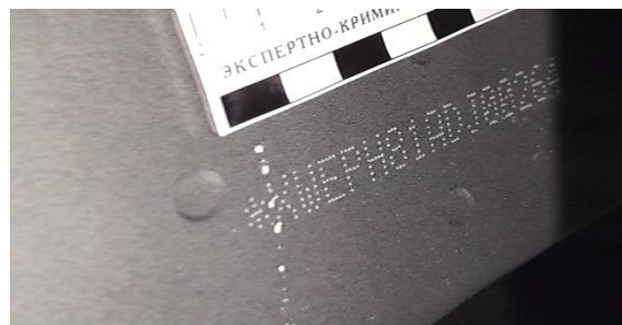
Рис. 2.53. Российский VIN в подкапотном пространстве
