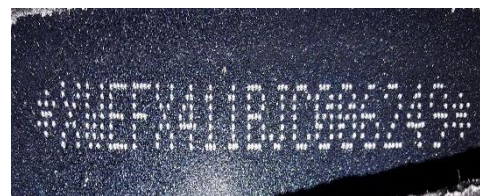
Рис. 2.58. VIN автомобиля KIA Cerato под передним пассажирским сиденьем
