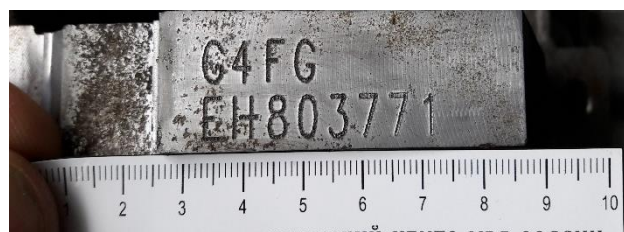
Рис. 2.59. Серийный номер двигателя автомобиля KIA Cerato
