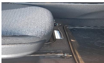
Рис. 2.43. VIN под передним пассажирским сиденьем автомобиля KIA Soul
