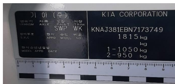
Рис. 2.42. Заводская маркировочная табличка автомобиля KIA Soul
