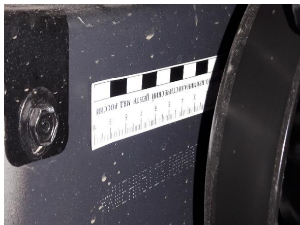
Рис. 2.19. VIN автомобиля KIA Seed
