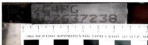
Рис. 2.46. Серийный номер двигателя автомобиля KIA Soul
