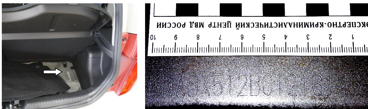
Рис. 2.63. VIN автомобиля KIA Picanto
