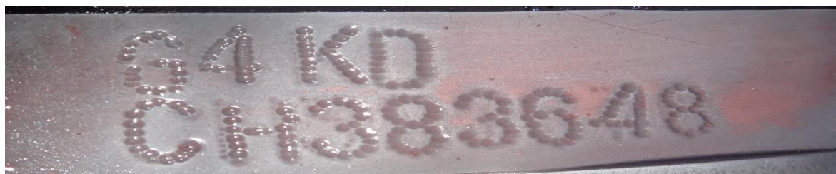
Фото 12. Маркировочная площадка двигателя после проведения химического травления
