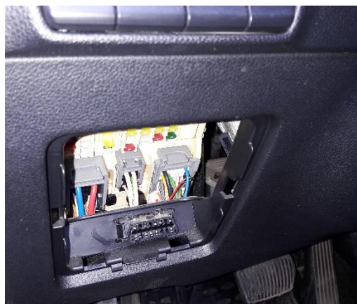
Рис. 2.20. Место расположения разъема для подключения диагностического сканера и считываемый с его помощью VIN автомобиля KIA Seed
