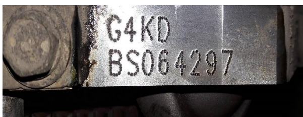
Рис. 2.59. Серийный номер двигателя автомобиля KIA Cerato
