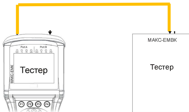
Рис. 10.2. Соединение тестера МАКС-ЕМК с устройством образования шлейфа и анализа трафика пакетных сетей МАКС-ЕМБК
