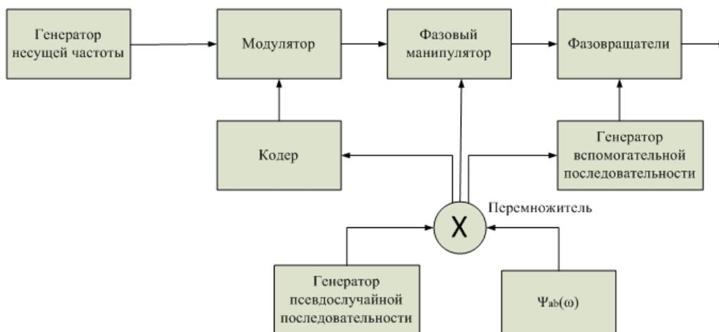
Рис. 4. Часть структурной схемы передатчика адаптивной системы с подключением вейвлет-функции
