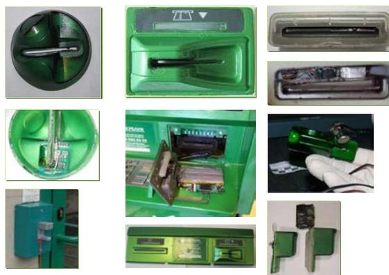
Рис. 1. Скимминг-оборудование и его содержимое
