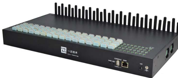
Рис. 3.9. GSM -шлюз, поддерживающий 32 SIM -карты
