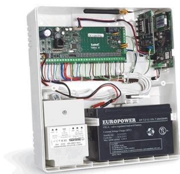
Некоторые приёмно-контрольные приборы, например популярный «Сигнал-20», не имеют встроенного блока питания и для их подключения, требуется отдельный бесперебойный источник питания с аккумулятором. Все приёмно-контрольные приборы оснащены «тампером». Это контакт несанкционированного вскрытия. При попытке вскрыть корпус прибора пожарной или охранной сигнализации, этот контакт размыкается и на пульт централизованного наблюдения придёт информация о попытке взлома прибора.
