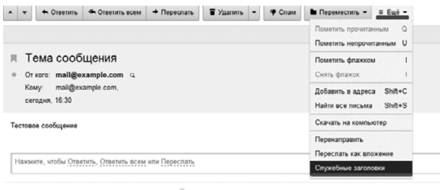
Рис. 7. Поиск служебных заголовков сообщения в почте mail.ru (кнопка «Еще» на панели инструментов, далее – «Служебные заголовки»)
