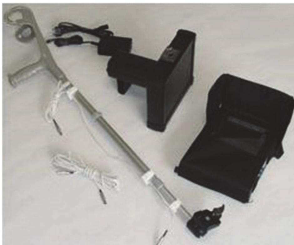
Рис. 25. Переносной флюороскоп
