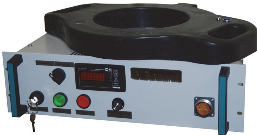
Рис. 27. Портативный дефектоскоп
