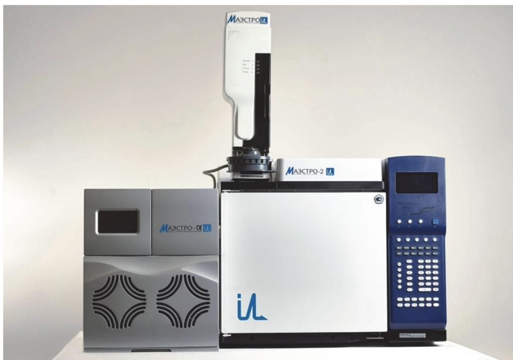
Рис. 35. Внешний вид газохромато-масс-спектрометра
