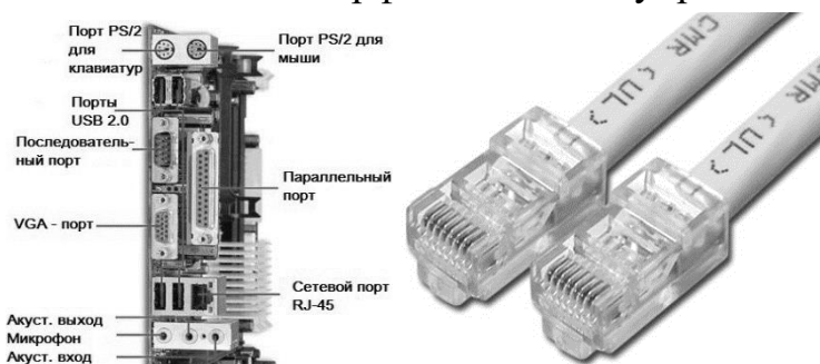
Рис. 6.21. Порты материнской платы и сетевой кабель
