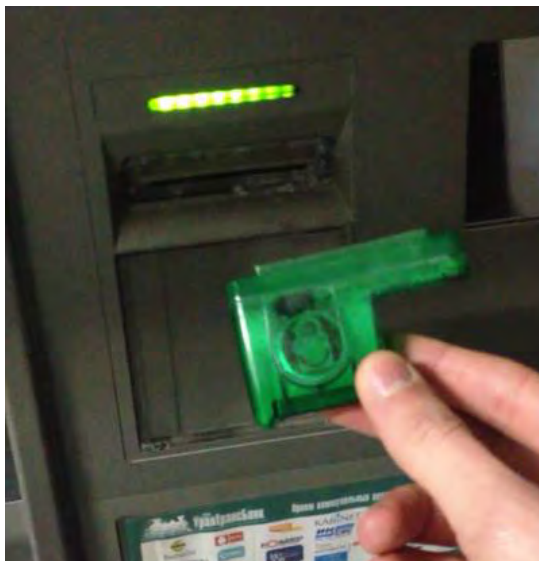
Рис. 20. Процесс установки скиммингового оборудования
