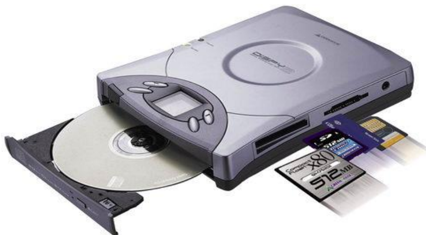
Иллюстрация № 19. Устройство для записи информации с карт памяти на диски CD-R/RW без использования (ноутбука) компьютера.
