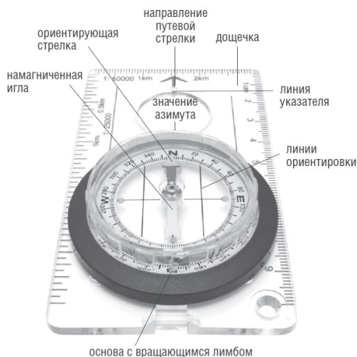
Рис. 17.3. Устройство современного компаса
