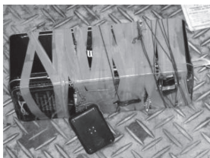
Рис. 17.27. СВУ с часовым взрывателем, изготовленным из бытового электронного таймера
