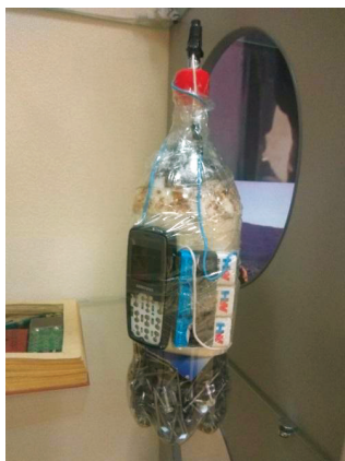
Рис. 17.26. СВУ радиоуправляемое, в качестве радиовзрывателя используются сотовый телефон, элементы питания и электродетонатор
