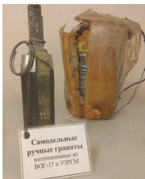
Рис. 17.25. СВУ натяжного действия в качестве средства взрывания используется запал УЗРГМ
