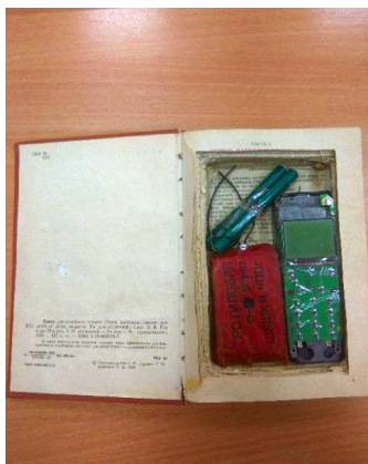
Рис. 17.26. СВУ радиоуправляемое, в качестве радиовзрывателя используются сотовый телефон, элементы питания и электродетонатор
