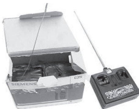
Рис. 17.31. СВУ радиоуправляемое, в качестве радиовзрывателя используются приёмо-передающее устройство и элементы питания радиоуправляемой игрушки и электродетонатор
