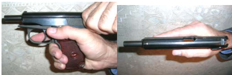
Фото 19. Поставить на затворную Фото 20. Осмотреть патронник. задержку.
