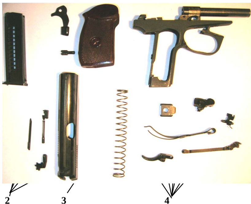
Фото 1. Основные части и механизмы пистолета:
