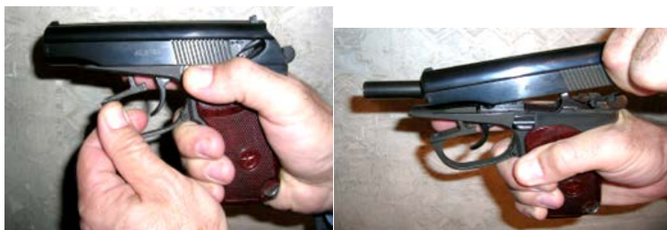
Фото 21. Оттянуть спусковую Фото 22. Отделить затвор от рамки. скобу.
