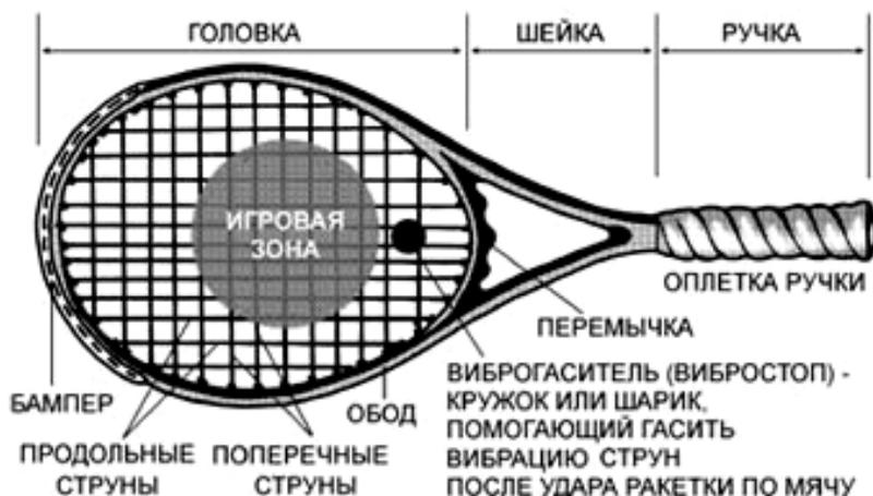
*Рис. 18. Строение теннисной ракетки*
