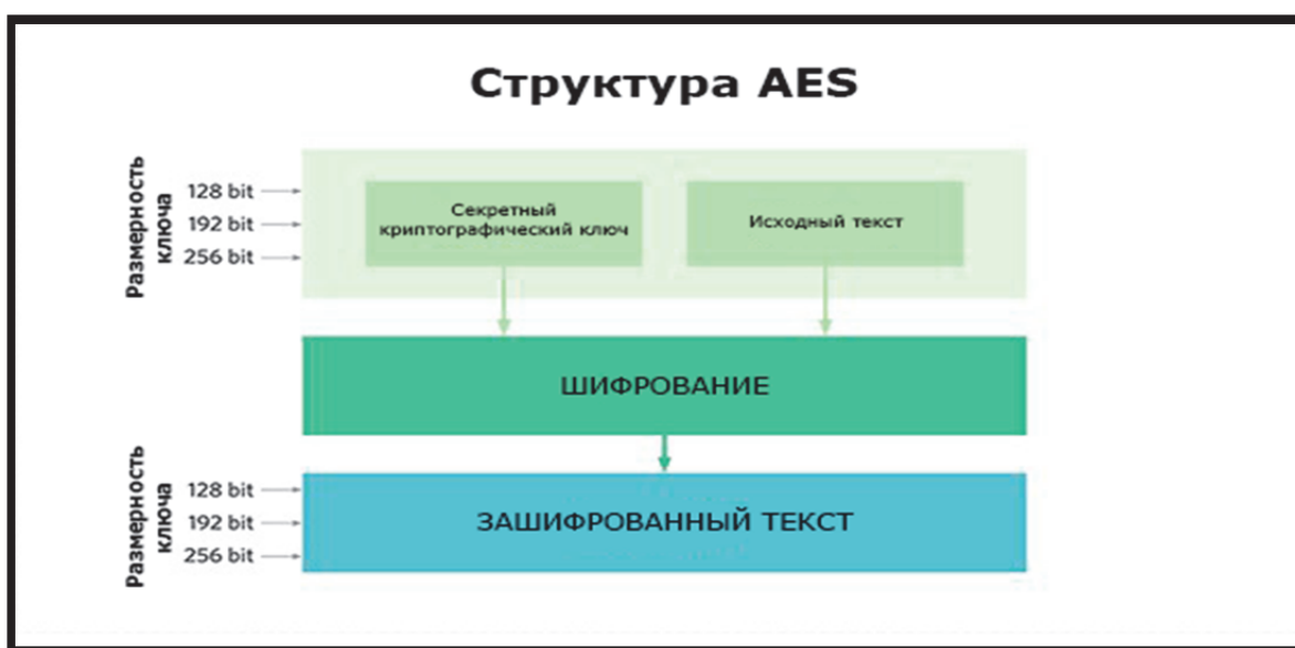
Иллюстрация 1. Структура работы симметричного алгоритма блочного шифрования (AES, Rijndael)
