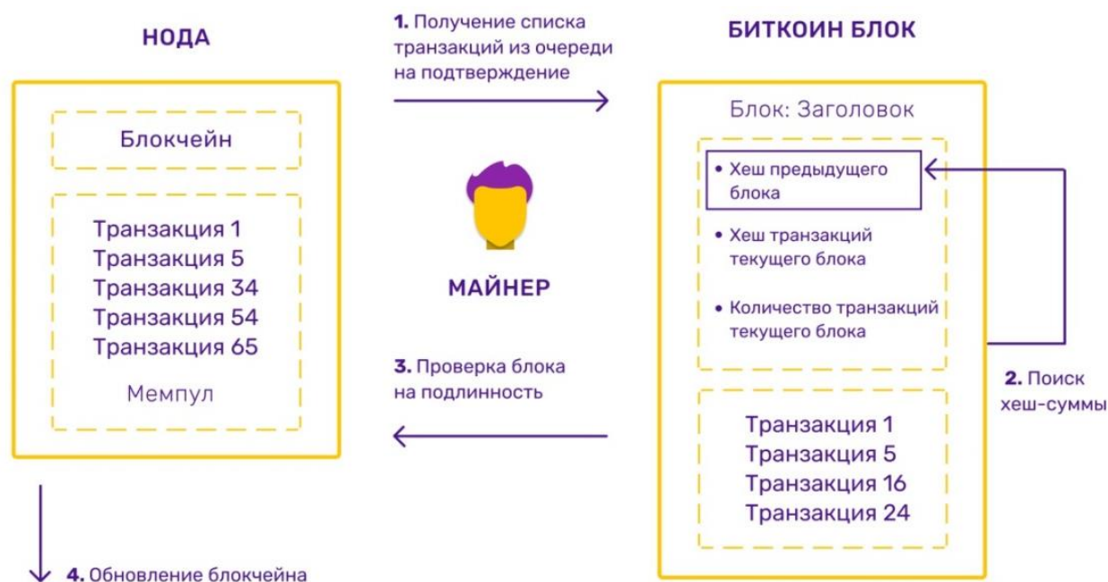
Рисунок 35 – Структура блока в системе «Биткойн» и добавление нового блока в блокчейн
