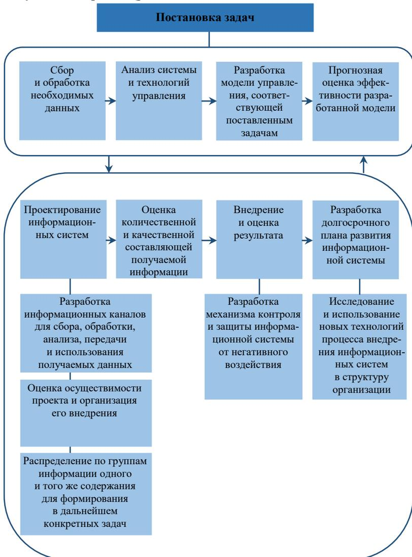
Рис. 5.1. Этапы разработки информационной системы, обеспечивающей реализацию технологии принятия решений
