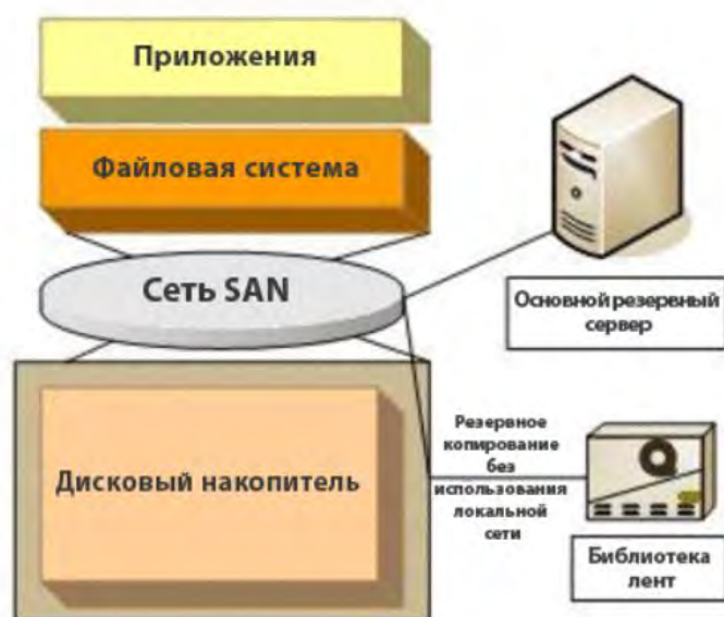
Рис. 1. Структура работы системы резервного копирования
