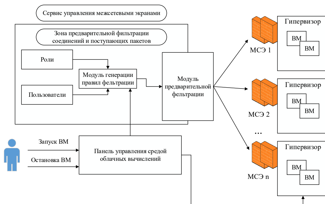
Рис. 2. Схема управления межсетевыми экранами для метода информационного взаимодействия
