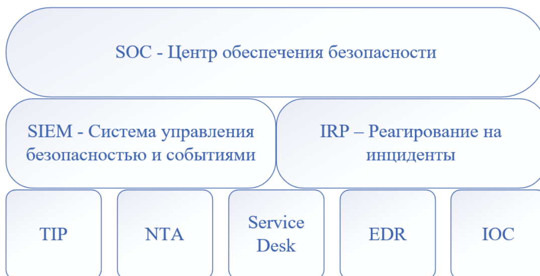
Рис. 1. Структура центра мониторинга информационной безопасности
