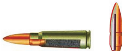
Рис. 12. Патрон 7,62 х 39 мм ПС и пуля патрона 7,62 х 39 мм ПС с термоупрочненным сердечником
